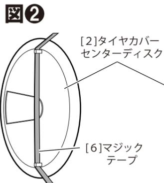
[2]タイヤカバーセンターディスクの裏の上下に接着されているリングに[6]マジックテープを通します。
