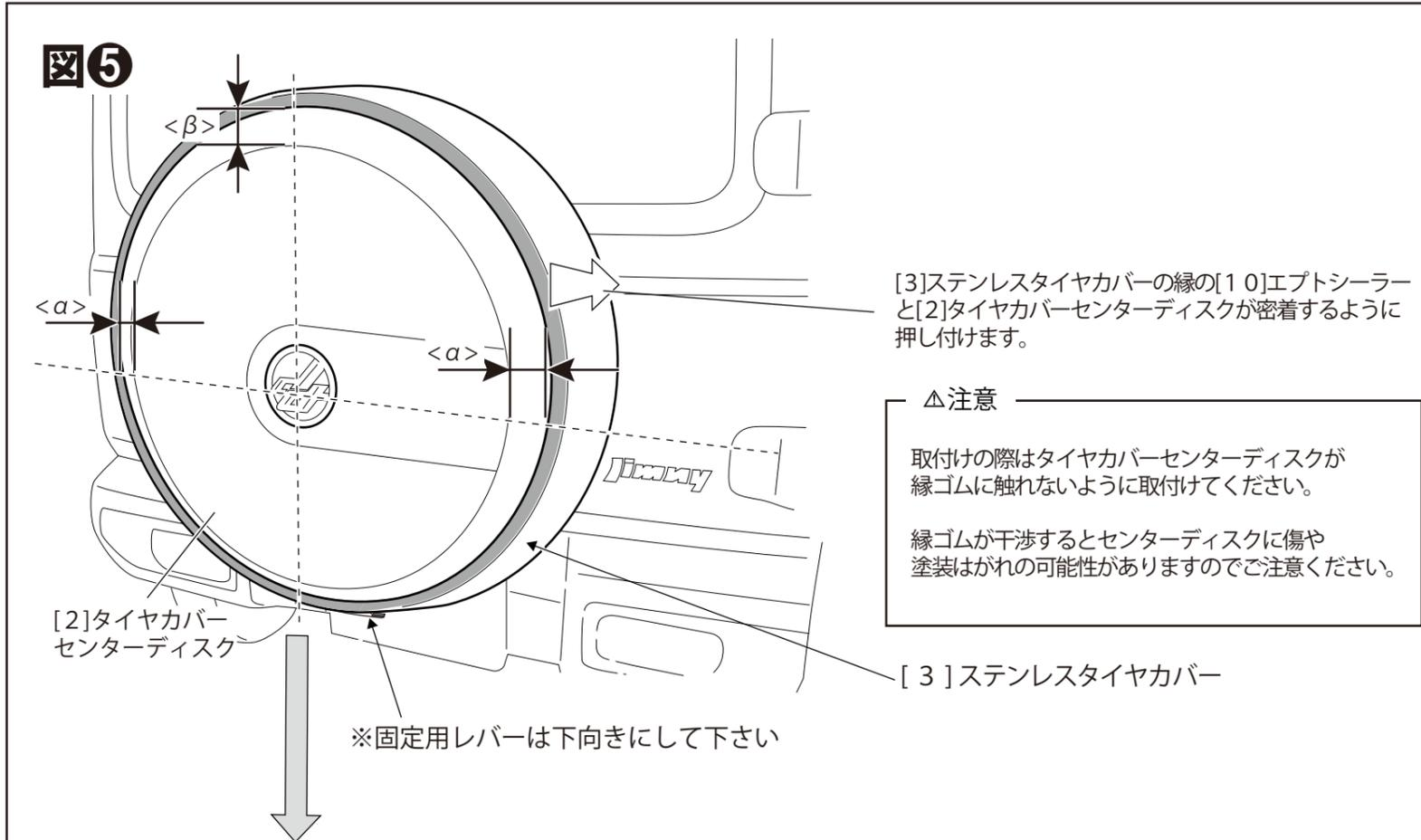
[3]ステンレスタイヤカバーの縁の[10]エプトシーラーと[2]タイヤカバーセンターディスクが密着するように押し付けます。
