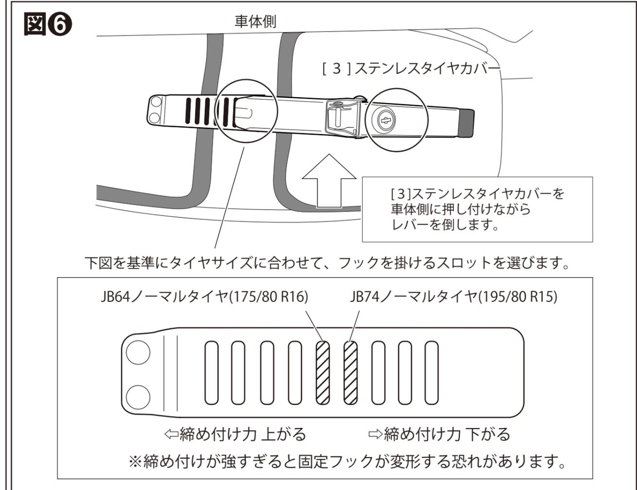
手順⑦ 図⑥、⑦を参考にレバーを倒してカバーを固定します。タイヤカバー全体にガタつきや緩みが無いことを確認して、鍵を[D]ロック用キーで閉めて、レバーを固定します。
