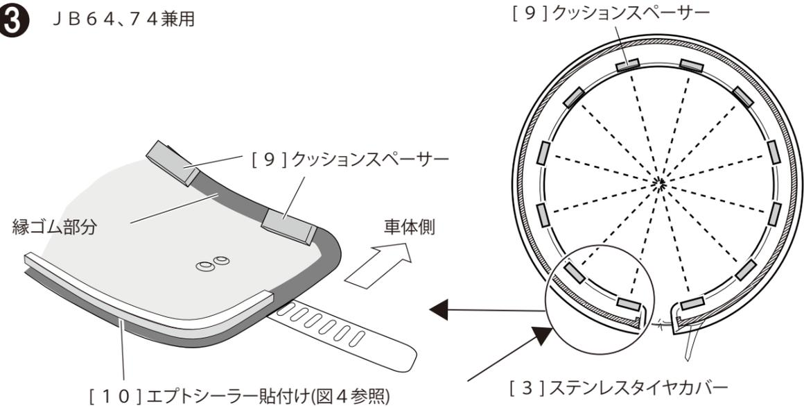
手順④ [3] ステンスタイヤカバーの縁ゴムに[10]エプトシーラーを貼り付けます。 ※貼付け面は清掃脱脂を行って下さい。
